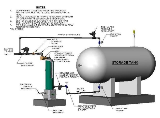
TYPICAL INSTALLATION w/ ELECTRIC VAPORIZER
